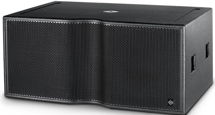
Der SCP ist der doppel 18" Sensor-Control Subwoofer im Bassreflex-Design für alle leistungsstarken CODA Audio Fullrange-Systeme, wie z.B. AiRAY, CiRAY oder ViRAY Line-Array Systeme.
